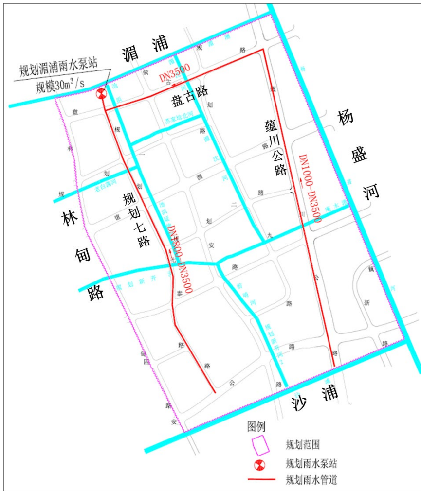
图5-18 湄浦排水系统雨水系统布局图
