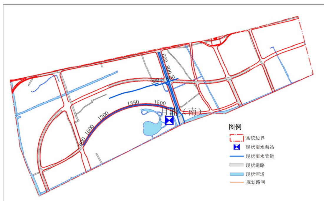
图5-79 月浦（南）系统现状雨水设施图
